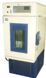
100 Liter Klimakammer -40 bis 180°C / 10 bis 98%rF.
