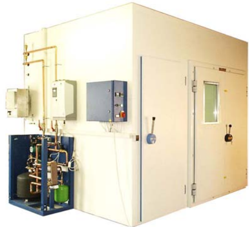
12m 3 Klimaprüfzelle -10 bis 80°C / 10 bis 98%rF.
