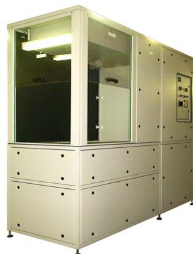
Klimakabine für hochgenaue Messmaschinen Temperatur konst.: 20°C +/- 0.2K Feuchte konst.: 50%rF.
